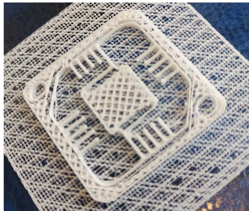
Макет STEP модели QFN-корпуса, распечатанный на 3d принтере с целью визуального обнаружения дефектов проектирования
