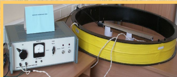
Установка для измерения экранирующих свойств рулонных материалов
