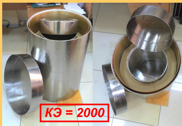
Экранированный бокс для биологических экспериментов (разработка ЦНИИ КМ «Прометей» совместно с ИЗМИРР РАН)
